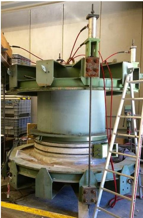
Bei jeder Druckstufe wird das Becken täglich auf Leckagen überprüft. Doch der MineralDicht sperr hält absolut dicht, bis mindestens 2,5 bar Wasserdruck.
