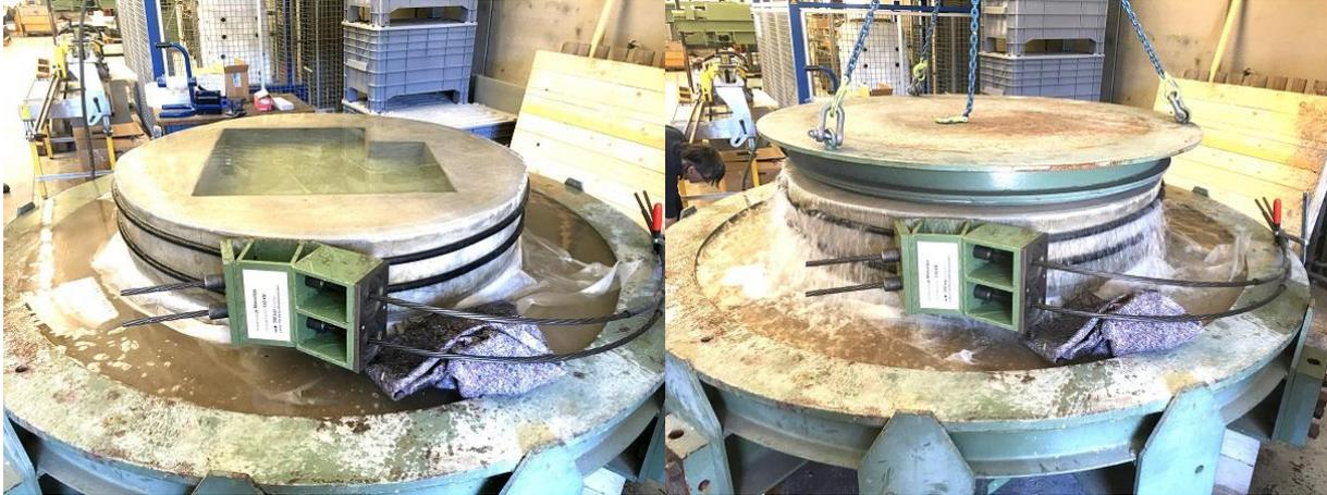
Ein Drucktopf wird auf das Betonbecken gesetzt und 0,5 bar Wasserdruck versehen. Dieser Druck bleibt für 1 Woche, anschließend wird er wöchentlich um 0,5 bar gesteigert, bis auf 2,5 bar. Mehr ist im Prüfaufbau nicht möglich.
