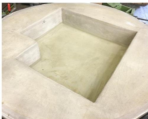
Zunächst stellt die MPA ein Betonbecken her, in dem Haftspritzbewurf von epasit aufgetragen wird. Nach einem Tag Reaktionszeit folgt die 15 mm starke Abdichtung aus MineralDicht sperr. Auch die Ecken werden mit Hohlkehlen aus MineralDicht sperr ausgebildet. Die Oberflächen glatt abgezogen, wird das Becken zur Ausreaktion für 14 Tage mit Wasser gefüllt.
